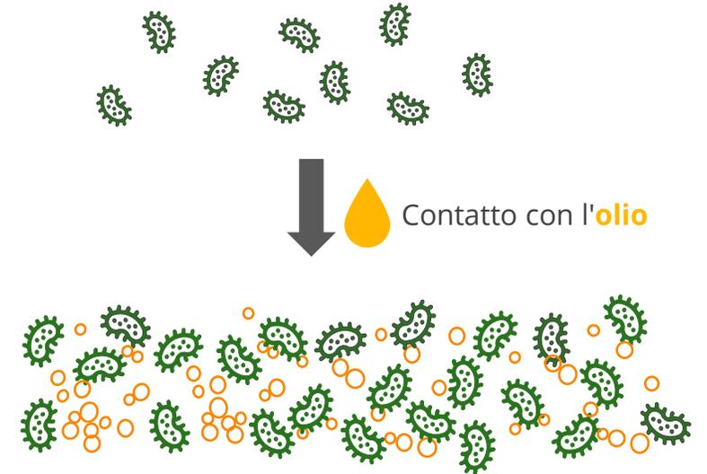
I batteri proliferano all'interno del cavo, degradando l'**olio** e producendo **biosurfattanti**.
